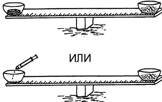
**Этап 1:** Поставьте ластик на ребро и положите на него линейку так, чтобы ее концы уравновешивали друг друга, и линейка располагалась строго горизонтально. Ластик будет находиться на середине линейки.
